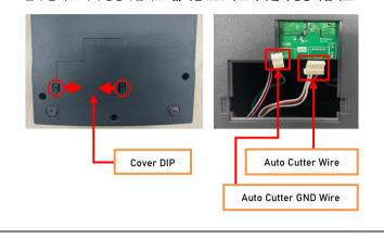
7. Auto Cutter Wire 와 Auto Cutter GND Wire 를 방향에 맞추어 Auto Cutter Connector 와 Auto Cutter GND Connector(빨간색 사각형)에 삽입하십시오.
