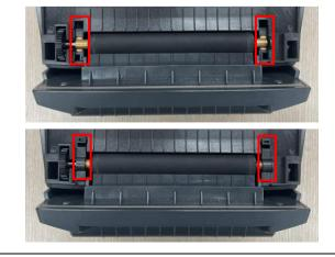
6. Printer 바닥 면이 정면으로 향하게 하십시오. Hook(빨간색 원)를 내측 방향으로 눌러 Cover DIP 을 분리하고, Auto Cutter Wire 와 Auto Cutter GND Wire 를 하기 그림과 같이 보이게 정형하십시오. ※ 다른 Wire 와 꼬이지 않게 정형 하십시오.
